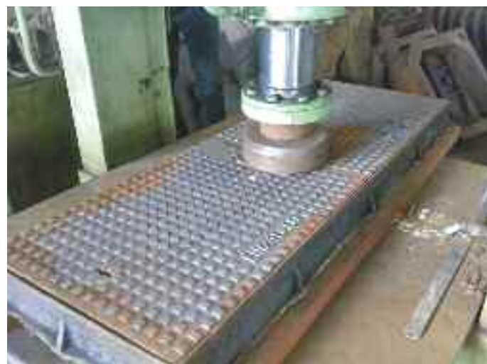
Prove di carico su dispositivo di coronamento e di chiusura
